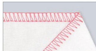
2本糸縁かがり 2本の糸で布端をかかります。糸の節約に。
