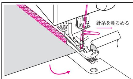
**2** 生地を90度回転させ、**1**でゆるめた糸をもとに戻して押え金を下げるから再び縫いはじめる。
