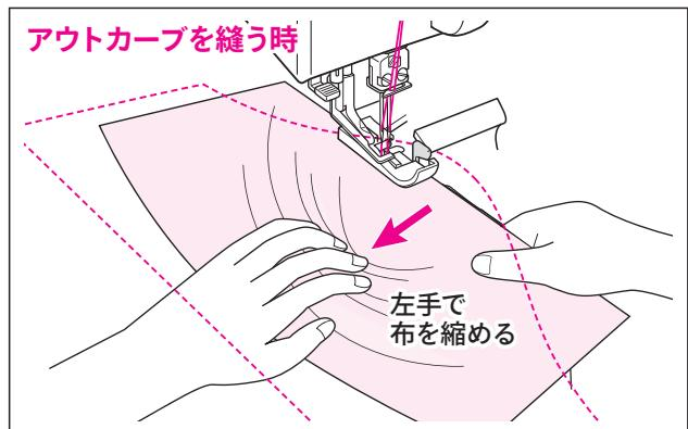
カーブ(突き出た)部分を左手で縮めて、右手で手前の布を右方向に引き出しながら縫う。このときメスから針落ち位置までが直線になるようする。
