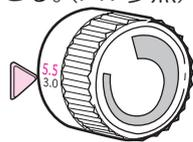
**4** 送り目&巻きロック切換ダイヤルを「普通ロック」側の数字0.75～4に合わせる。(P17参照)
