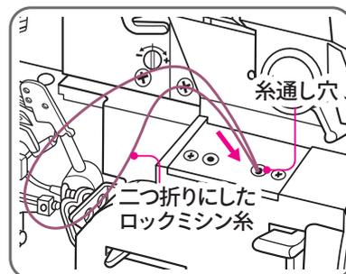
**4** 糸がすべて通り抜けてしまわないように二つ折りにした部分を指で持ったままエアレバーを押す。「固定の解除」を行う(P10参照)
