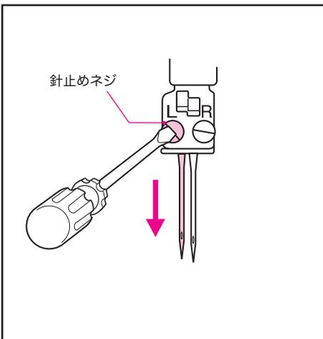
**3** 新しい針を付属の掃除用ブラシに差し込み「針頭部の平らな面」が後ろ向きになるようにして、針留の穴の奥まで差し込む。
