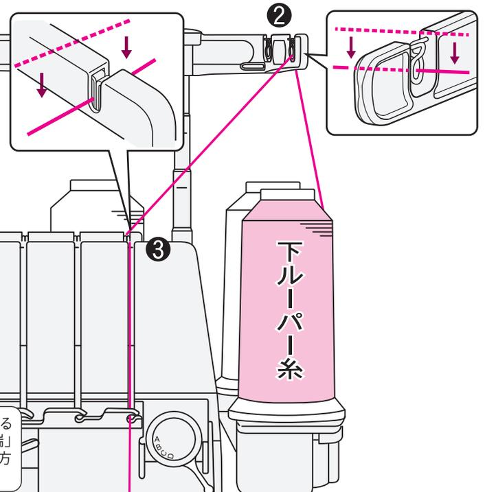
エアレバーを押し下げると「下ルーパーの先端」から糸が勢いよく右方向へ飛び出します。
