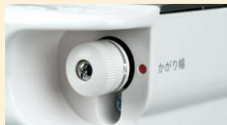
かがり幅(切り幅)もダイヤルひとつで調整できます。3～5mmの範囲で選択できます。
