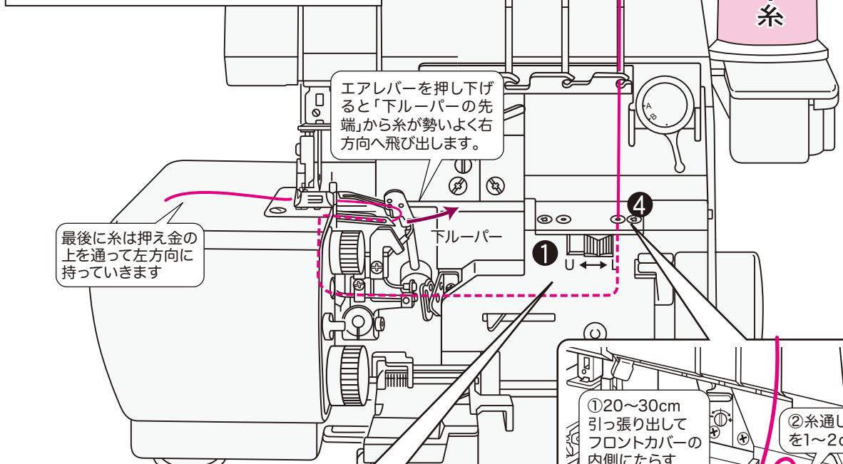
エアレバーを押し下げると「下ルーパーの先端」から糸が勢いよく右方向へ飛び出します。
