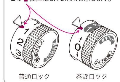
このミシンは A. 普通ロック、B. 変形巻きロックの2種類の基本縫いを、面倒な調節なしで簡単に切り換えることができます。
