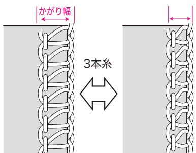
「かがり幅ダイヤル」を回して、3.0mm～5.0mmの範囲で調節してください。
