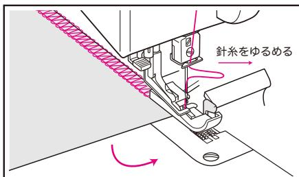
**2** 生地を90度回転させ、**1**でゆるめた糸をもとに戻して抑え金を下げるから再び縫いはじめる。
