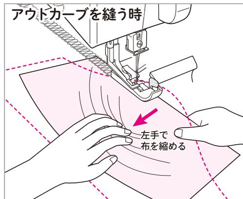
カーブ(突出した)部分を左手で縮めて、右手で手前の布を右方向に引き出しながら縫う。このときメスから針落ち位置までが直線になるようにする。
