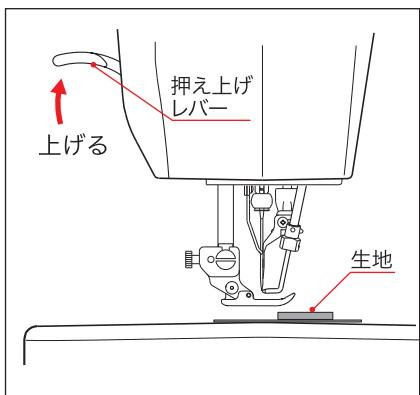
② 押え金の左側にある「段縫いボタン」を押しながら、押え金を下げます。すると押え金が平行に固定されます。
