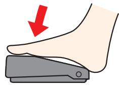
※コントローラーを3秒以上踏むと、足を離しても離した時点の巻き取り速度で回り続けます。
