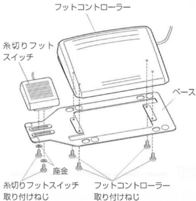
※ フットコントローラー取り付けねじ（4個）と糸切りフットスイッチ取り付けねじ（2個）と座金（2個）を外し、フットコントローラーと糸切りフットスイッチを外します。
