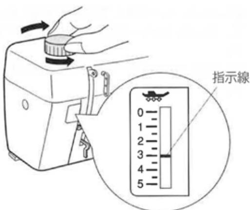
普通の布のときは、押さえ圧調節ダイヤルをまわして、指示線を「3」に合わせます。
