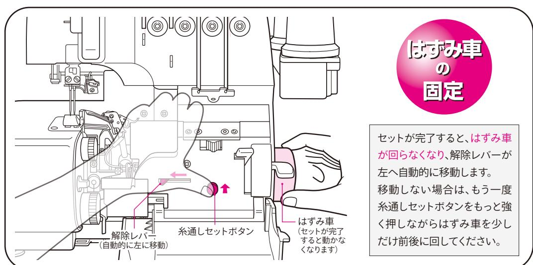
セットが完了すると、はずみ車が回らなくなり、解除レバーが左へ自動的に移動します。
