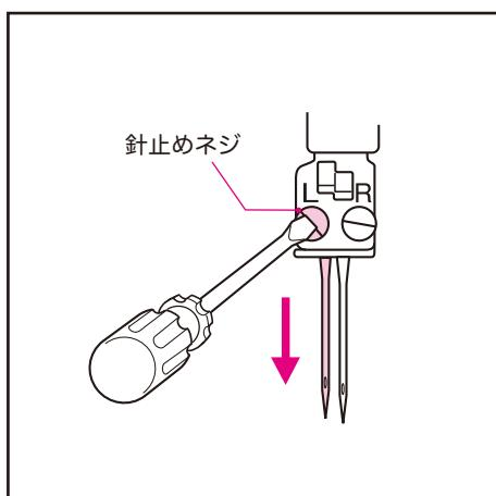
**3** 新しい針を付属の掃除用ブラシに差し込み「針頭部の平らな面」が後ろ向きになるようにして、針留の穴の奥まで差し込む。
