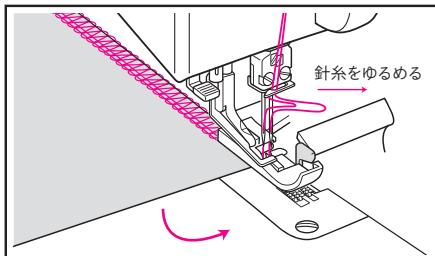
**2** 生地を90度回転させ、**1**でゆるめた糸をもとに戻して押え金を下げるから再び縫いはじめる。
