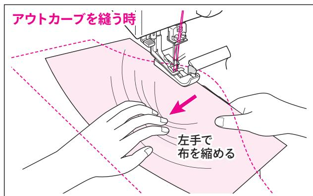
カーブ(突き出た)部分を左手で縮めて、右手で手前の布を右方向に引き出しながら縫う。このときメスから針落ち位置までが直線になるようにする。
