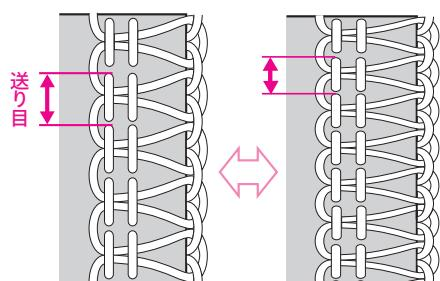
「送り目ダイヤル」を回して、普通ロック・巻きロックともに0.75～4mmの範囲で調節できます。
