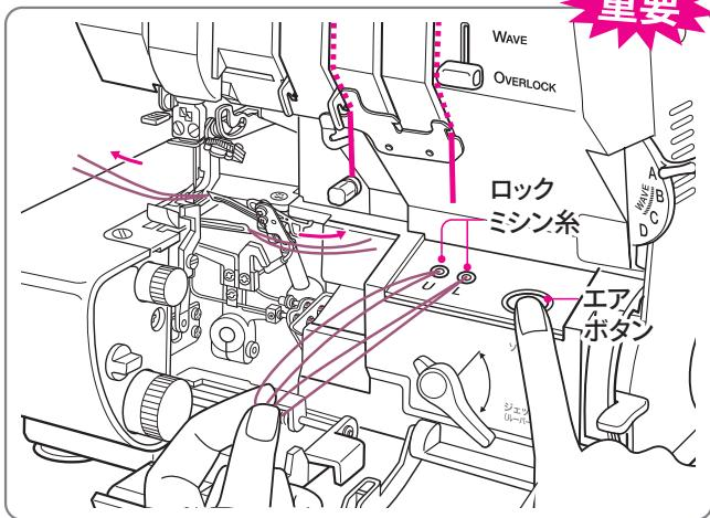
**5 エアスルーで通したロックミシン糸をパイプの途中からピンセットで引き出す(この時ルーパーの先から出ているロックミシン糸は抜けないように手で持っておく)。**
