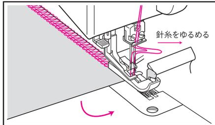
**2** 生地を90度回転させ、**1**でゆるめた糸をもとに戻して押え金を下げてから再び縫いはじめる。
