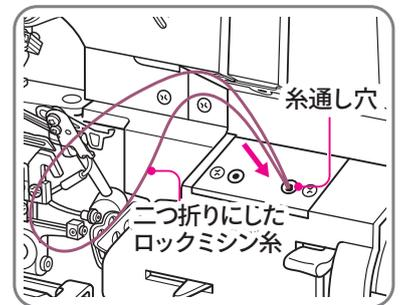
**4** 糸がすべて通り抜けてしまわないように二つ折りにした部分を指で持ったままエアレバーを押す。「固定の解除」を行う(P10参照)
