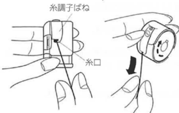
③ 糸を引いて、糸調子ばねの下を通し、糸口に引き出します。
