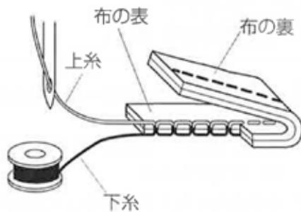
上糸と下糸が布のほぼ中央でまじわります。糸調子が正しく調節されていないと、ぬい目がきたなくなり、布にしわがよったり、糸が切れたりします。糸調子ダイヤルをまわして調節してください。
