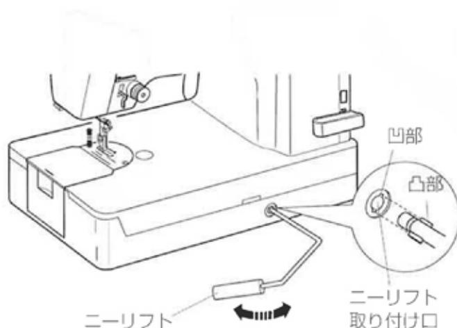
ニーリフトは手を使わずに押さえのあげ下げができるので、キルトなどをぬうときに使うと便利です。取り付けは、ニーリフトの凸部をニーリフト取り付け口の凹部に合わせ、差し込みます。
