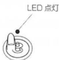
下糸巻きをするときに使います。糸巻きレバーを糸巻き側にし、糸巻きボタンを押すと糸巻き LED が点灯します。巻き終わると、糸巻きレバーがもとの位置にもどり糸巻き LED が消灯します。
