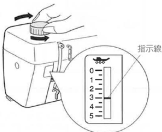
普通の布のときは、押さえ圧調節ダイヤルをまわして、指示線を「3」に合わせます。
