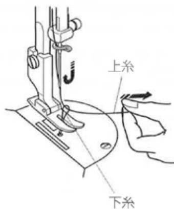
② 電源スイッチを入れて、針上下移動ボタンを押し針を下げ、もう1度ボタンを押して針をあげます。上糸を軽く引くと、下糸の輪が引き出されます。
