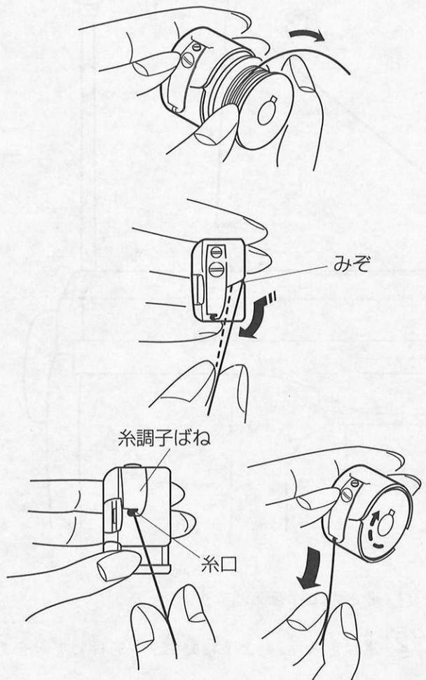
① 糸の端を矢印方向にたらして、ボビンケースに入れます。
