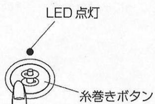
糸巻きレバーを糸巻き側にし、糸巻きボタンを押すと糸巻きLEDが点灯し、糸巻きをします。巻き終わると、糸巻きレバーがもとの位置にもどり糸巻きLEDが消灯します。
