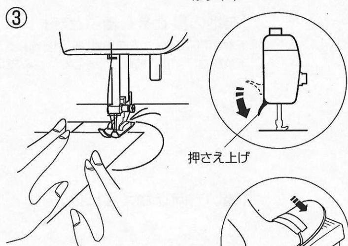
③押さえ上げをさげ、フットコントローラーを踏み、スタートします。
