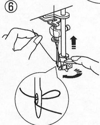
⑥ 上糸を軽く持ち、糸通しつまみを手前にもどして指をはなすと、針穴に糸の輪ができます。糸の輪を右側へ引き出します。
