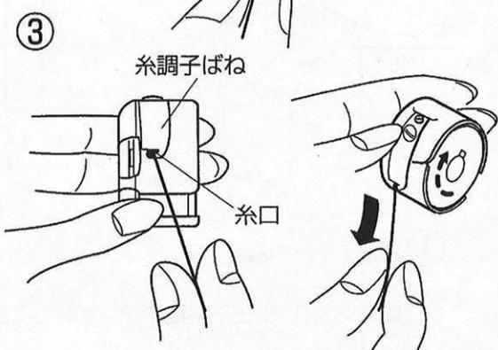
③ 糸を引いて、糸調子ばねの下を通し、糸口に引き出します。
