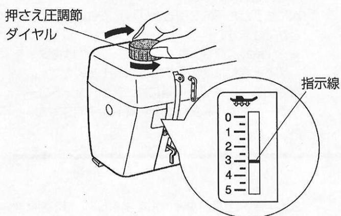
押さえ圧の調節は、押さえ圧調節ダイヤルをまわして調節します。
