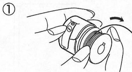
① 糸の端を矢印方向にたらして、ボビンケースに入れます。
