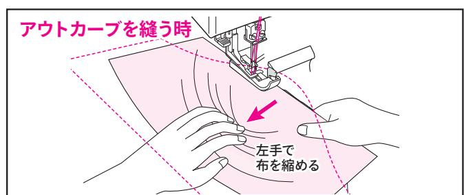
カーブ(突き出た)部分を左手で縮めて、右手で手前の布を右方向に引き出しながら縫う。このときメスから針落ち位置までが直線になるようにする。
