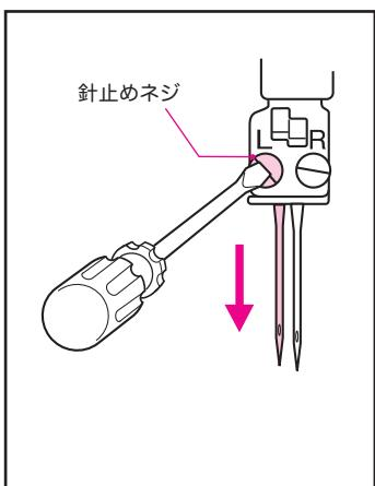
3 新しい針を付属の掃除用ブラシに差し込み「針頭部の平らな面」が後ろ向きになるようにして、針留の穴の奥まで差し込む。
