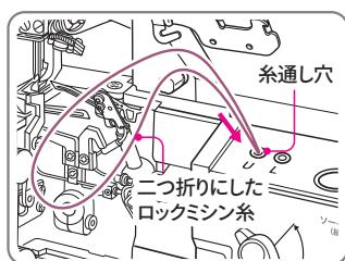
**4 糸がすべて通り抜けてしまわないように二つ折りにした部分を指で持ったままエアボタンを押す。「固定の解除」を行う(P20参照)**
