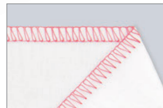
2本糸縁かがり 2本の糸で布端をかかります。糸の節約に。
