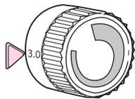
**3** 送り目&巻きロック切換えダイヤルを「普通ロック」側の数字0.75~4に合わせる。(P8参照)
