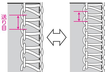
「送り目ダイヤル」を回して、普通ロック・巻きロックともに0.75～4mmの範囲で調節できます。
