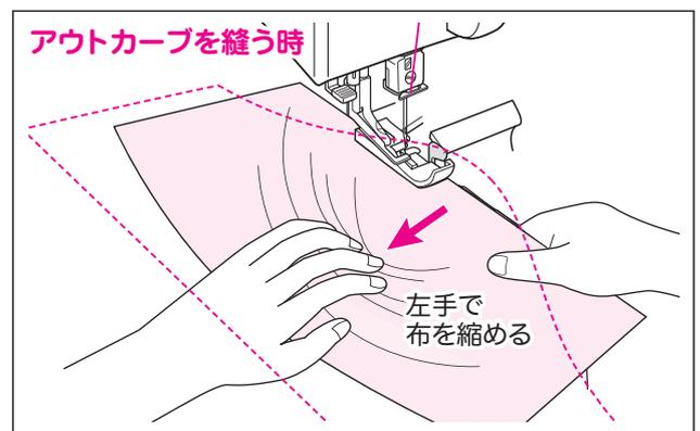
カーブ(突き出た)部分を左手で縮めて、右手で手前の布を右方向に引き出しながら縫う。このときメスから針落ち位置までが直線になるようにする。
