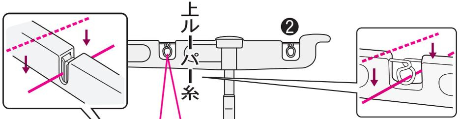
エアレバーを押し下げると「上ルーパーの先端」から糸が勢よく左方向へ飛び出します。
