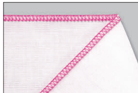
巻きロック (P10参照) オーガンジーやジョーゼットなど、薄物の縁かがりに最適。パーティードレスなどのフリルやコーサージュ作りには欠かせません。もちろん巻きロックでも縫い合わせができます。
