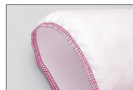
袖山のいせ込み 差動比(縮み量)を変えながら縫えるので自然ないせ込みに。
