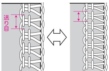
「送り目&巻きロック切換ダイヤル」を回して、普通ロック・巻きロックともに0.75~4 mmの範囲で調節できます。
