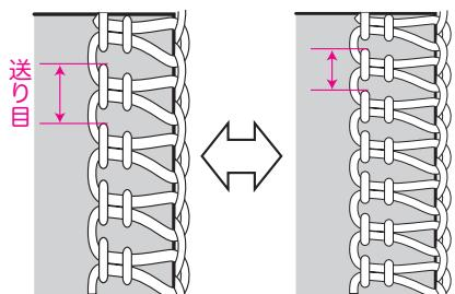
「送り目&巻きロック切換ダイヤル」を回して、普通ロック・巻きロックとともに0.75 ~ 4 mmの範囲で調節できます。
