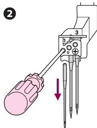
【注】針を取りはずした後、止めネジはゆるめたままにしてください（止めネジははずれない構造になっています）。
